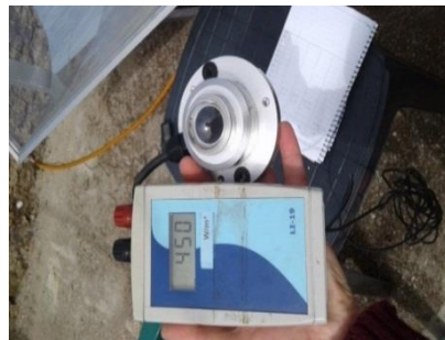
الشكل (7) حساس الحرارة، ومقياس الإشعاع الشمسي، والحوض المستخدمة في التجارب.
