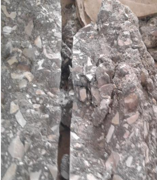
سطح الانهيار لتجربة ضغط عينة الببتون
