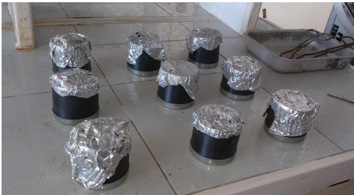
شكل ( 1 ) عينات قشور الفول السوداني في اسطوانات معدنية معدة للتفحيم
