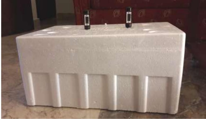
الشكل (12): طريقة وضع الموازين لقياس درجة الحرارة بعد إغلاق الصندوق.
