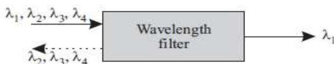
الشكل (6): مرشح يختار طولاً موجياً معيناً ويمنع الباقي، أو يمررها إلى المنفذ الثالث.
