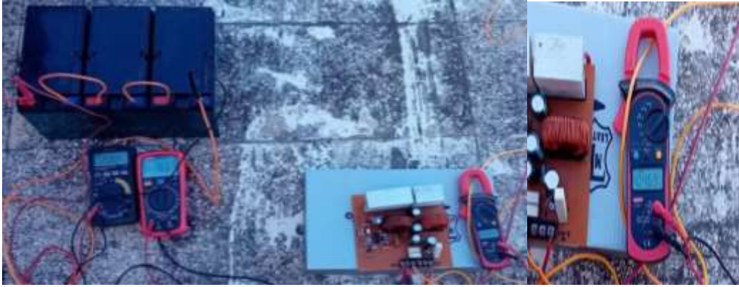
الشكل (20): قيم تيار وجهد البطاريات عند تيار دخل [A] 3.97 وجهد دخل [V] 46.9 .
