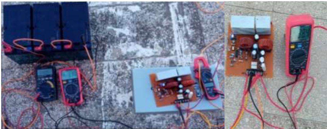
الشكل (22): قيم تيار وجهد البطاريات مع تيار دخل [A] 3.73 وجهد دخل [V] 38.4 .
