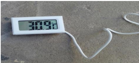
الشكل (7) مقياس درجة حرارة السوائل وحساس قياس درجة المحيط الخارجي والغطاء .
